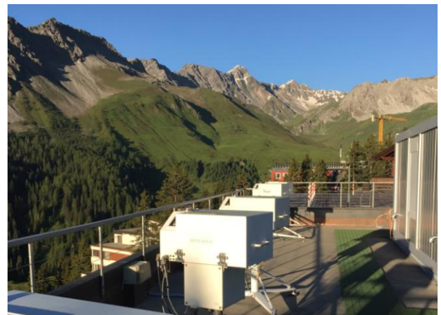
Figure 1 Spectrophotomètre solaire de type Brewer sur la terrasse du laboratoire d'Arosa
