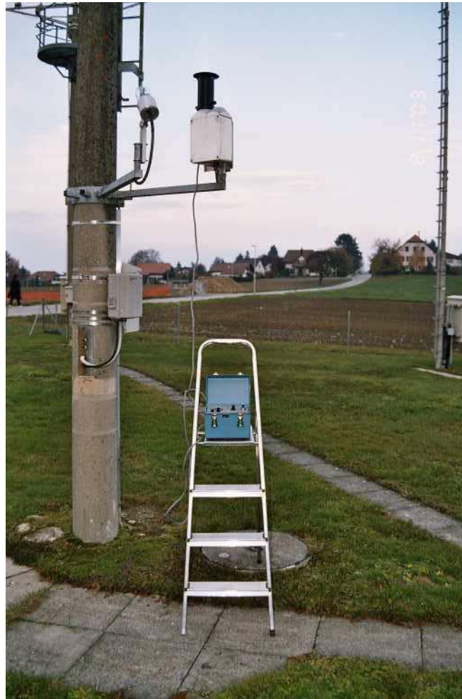
Abb. 1.4: Die Eichhappatur im Einsatz. Die Eichlampe ist im schwarzen Zylinder eingebaut. Die Speisungseinheit ist im blauen Koffer enthalten.
