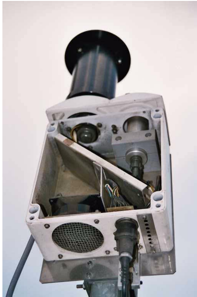
Abb. 1.3: Innere Struktur des Kastens der Strahlungsgeber. Links oben der Unterteil des Pyranometers mit aufgesetzter Eichlampe (schwarzer Zylinder, vgl. Kapitel 1.5), rechts der Unterteil des Photometers. Unten links der Ventilator. (Aufnahme: G. Converso)
