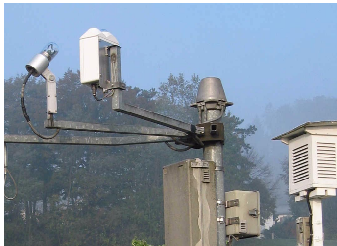
Abb. 1.2: Die 3 Strahlungsgeber in der ANETZ Standardaufstellung. Der Trägerarm des Heliometers (links im Bild) ist nach Süden ausgerichtet. Pyranometer (hinten mit Glaskuppel) und Photometer (vorne) sind zusammen am anderen Arm befestigt. Bei engen Verhältnissen sind die Geber am Windmast in derselben Konfiguration angebracht. Je nach Jahreszeit, beschatten sich Pyranometer und Heliometer gegenseitig, allerdings nur unwesentlich, da nur bei tiefstem Sonnenstand. (Aufnahme: A. Kunz)
