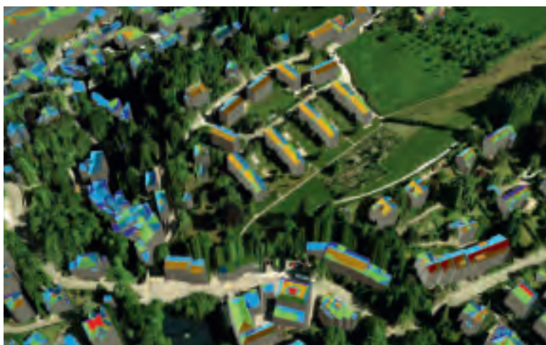
La carte qualitative montre les endroits idéaux pour une installation solaire. Le potentiel solaire d'une surface de toit – colorée en rouge s'il est bon et en bleu s'il est mauvais – dépend aussi de sa déclivité.
