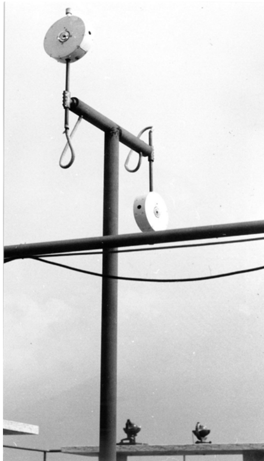
Abbildung 19: Aufstellung der vertikalen Pyranometer auf dem Dach in Locarno
