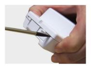
Veuillez ouvrir le couvercle avec un tournevis aux deux endroits indiqués à l'extrémité de la radiosonde.
