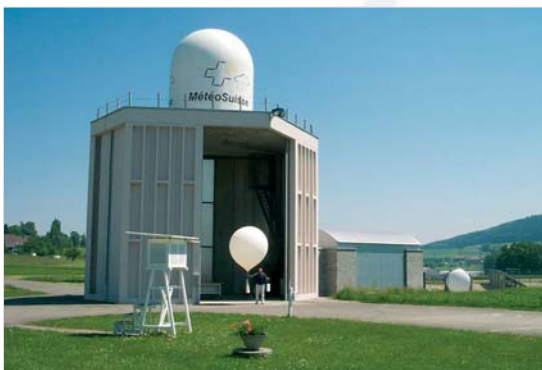
▼ Ballon atmosphérique avec radiosonde peu avant l'ascension.
